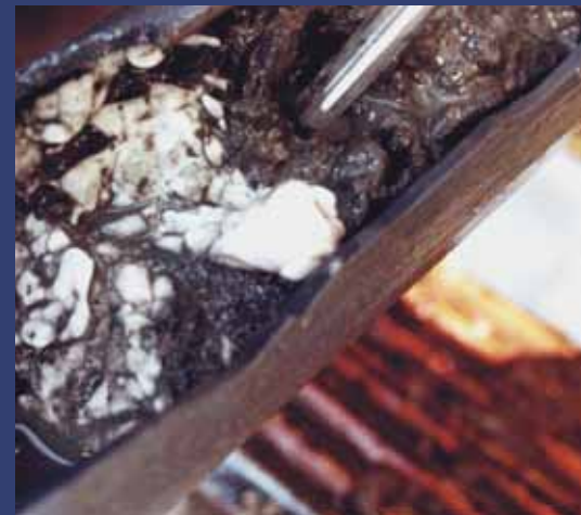
Газогидраты в грунтовых пробах выглядят как непрозрачные включения двух типов: крупные массивные комки с тонкими трещинами, заполненными осадком, и многочисленные более мелкие включения плитчатой формы, размером до 2 см. По данным газохроматографии, в составе газогидратов 99 % метана. Фото Я. Клеркса
